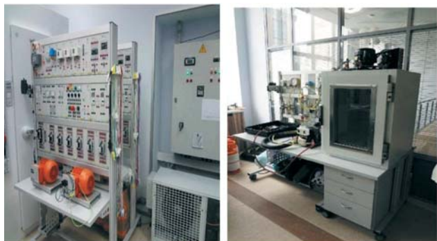
Стенды комплексной лабораторной работы «Самостоятельный монтаж холодильной установки и ее эксплуатация»
